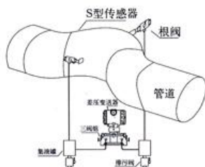
S 型传感器在水平直管道上的安装
